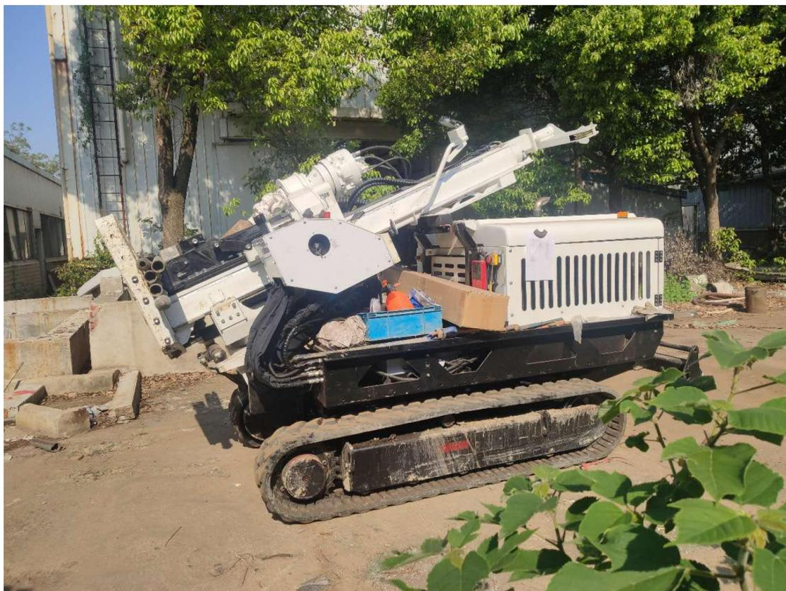
图 5.2.1-1 7822DT 型 Geoprobe 钻机
