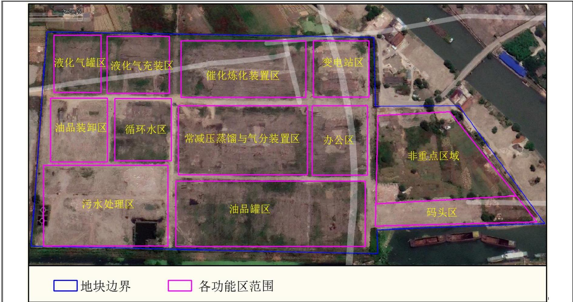
(8) 2020年5月地块历史影像图显示，地块内除污水处理区的生化沉淀池、雨水提升设施以及东侧大门未拆除以外，原有企业所有构建筑物、生产设施及产品均已拆除完毕。（说明：2020年12月，污水处理区的生化沉淀池、雨水提升设施已填埋，全场土地平整。）
