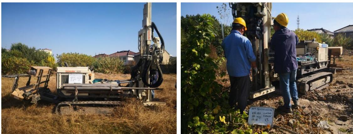
图 4.2-1 Geoprobe 土壤采样设备
