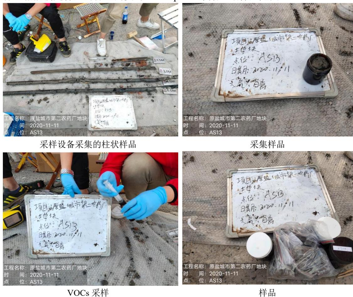
图 4.2-2 Geoprobe 采集土壤样品
