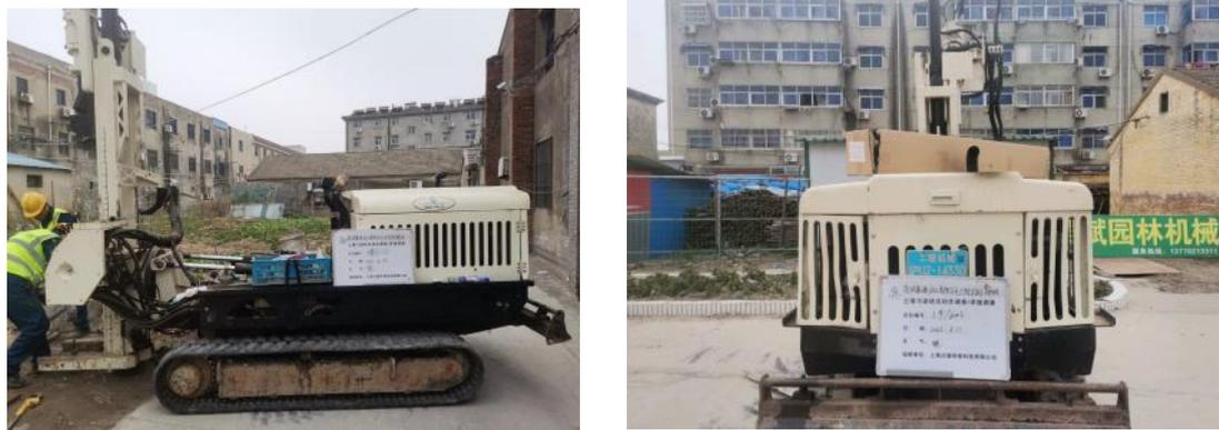
图 5.3.1-1 直推式土壤采样设备
