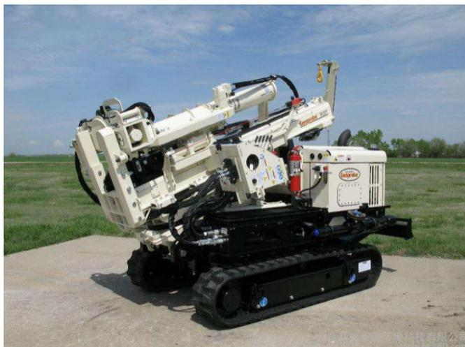
图 6.2.1-1 7822DT 型 Geoprobe 钻机
