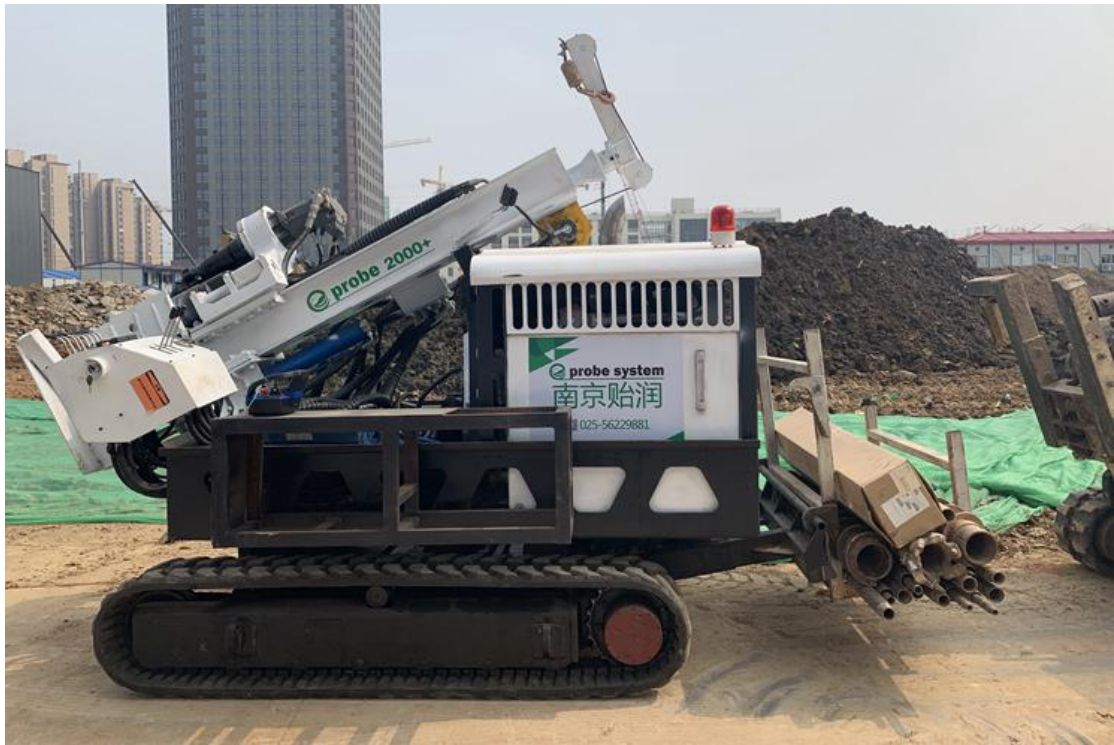
图5.2-1 EP2000+土壤地下水取样修复一体机
