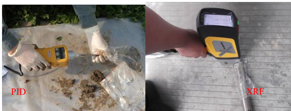
图5.2-2 现场PID 与XRF检测
