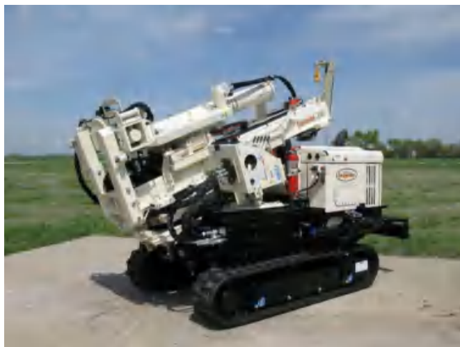
图 5.2.1-1 7822DT 型 Geoprobe 钻机
