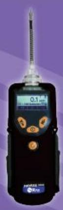
ppbRAE 3000 是一款当今市场上最灵敏的广谱手持式挥发性有机化合物 (VOC) 气体检测仪, 采用华瑞最新的第三代光离子化检测器 (PID), 提高了检测精度和响应时间, 检测范围达到 1ppb~10000ppm, 通过无线模块可以实现与控制台的无线数据传输和远程监控。可广泛应用在环保、职业卫生健康、应急救援、工业安全、石油石化等行业。
