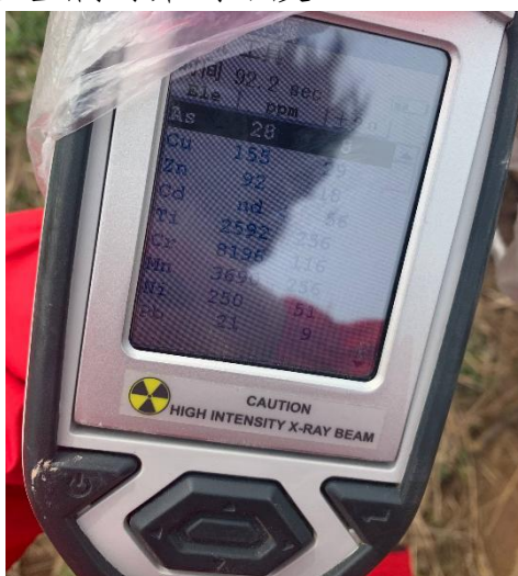
图 5-2 现场 PID 与 XRF 检测
